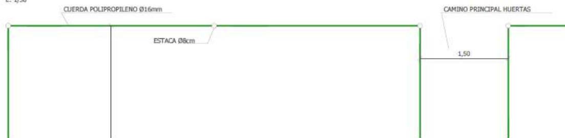
DETALLE DE SEPARACIÓN DE HUERTAS (ESTACAS Y CUERDA) E: 1/50
