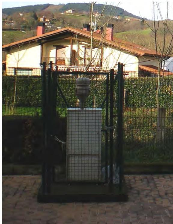
Figura 3.1. Captador de alto volumen Digital.
