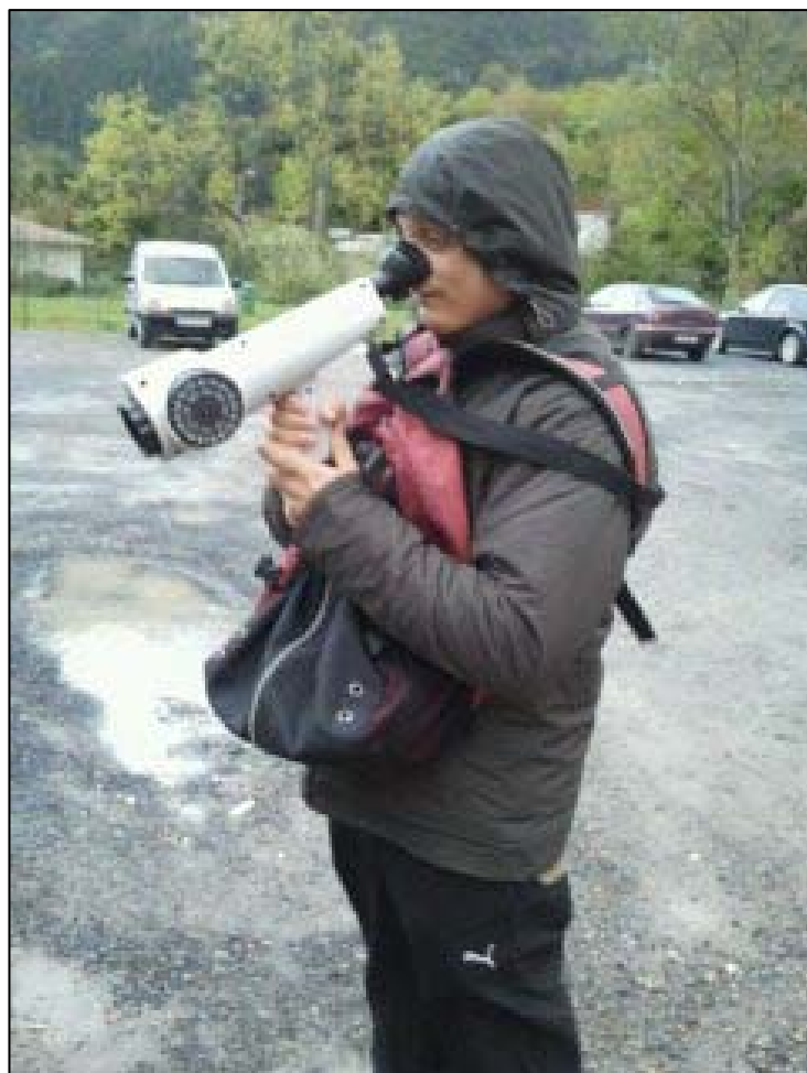
Figura 1.1. Ejemplo de realización de una medición de la concentración de olor “in-situ” mediante olfatometría de campo
