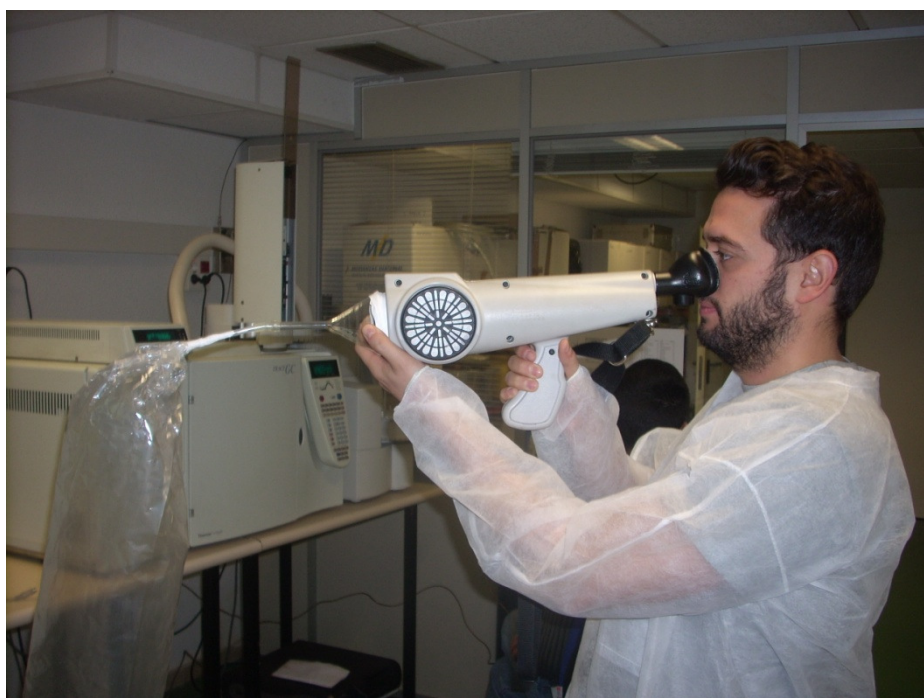
Ejemplo de cualificación de un técnico mediante percepción de olor en muestras constituidas por n-butanol de concentraciones conocidas en aire sintético
