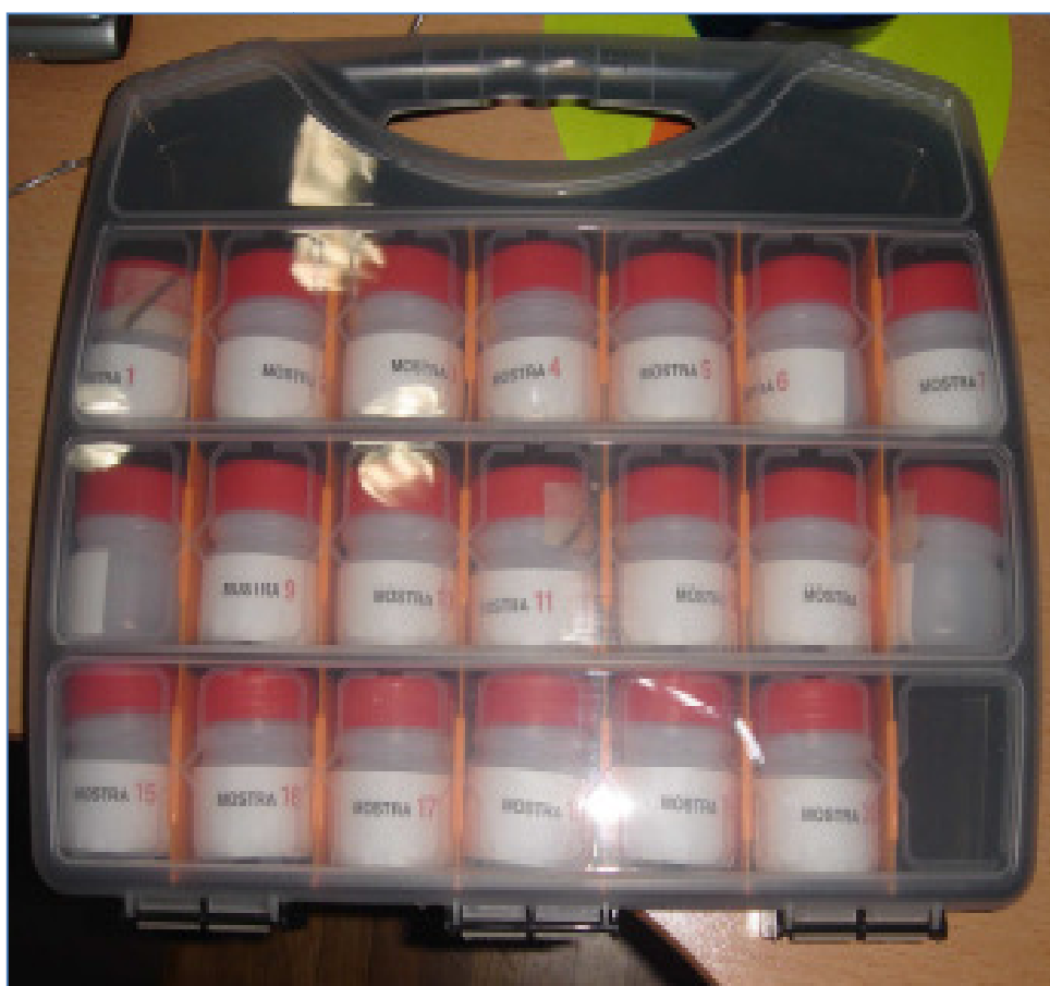
Muestras preparadas para el test con soluciones acuosas de n-butanol
