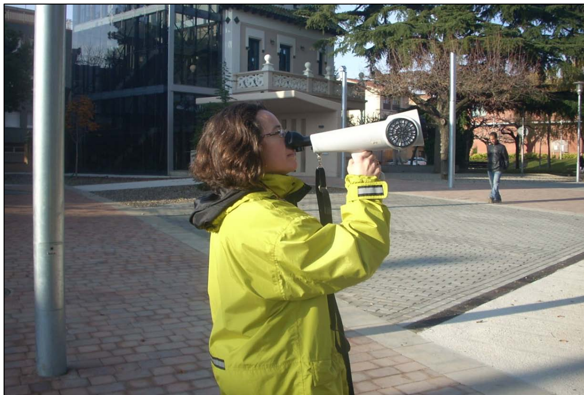
Figura 6.1: Fotografía de detalle de la utilización del olfatómetro de campo
