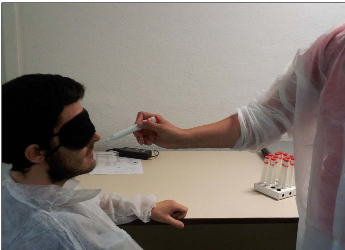
Figura 2.4: Fotografía del Test de validación odorífera para olfatómetros de campo mediante “sticks” impregnados de n-butanol
