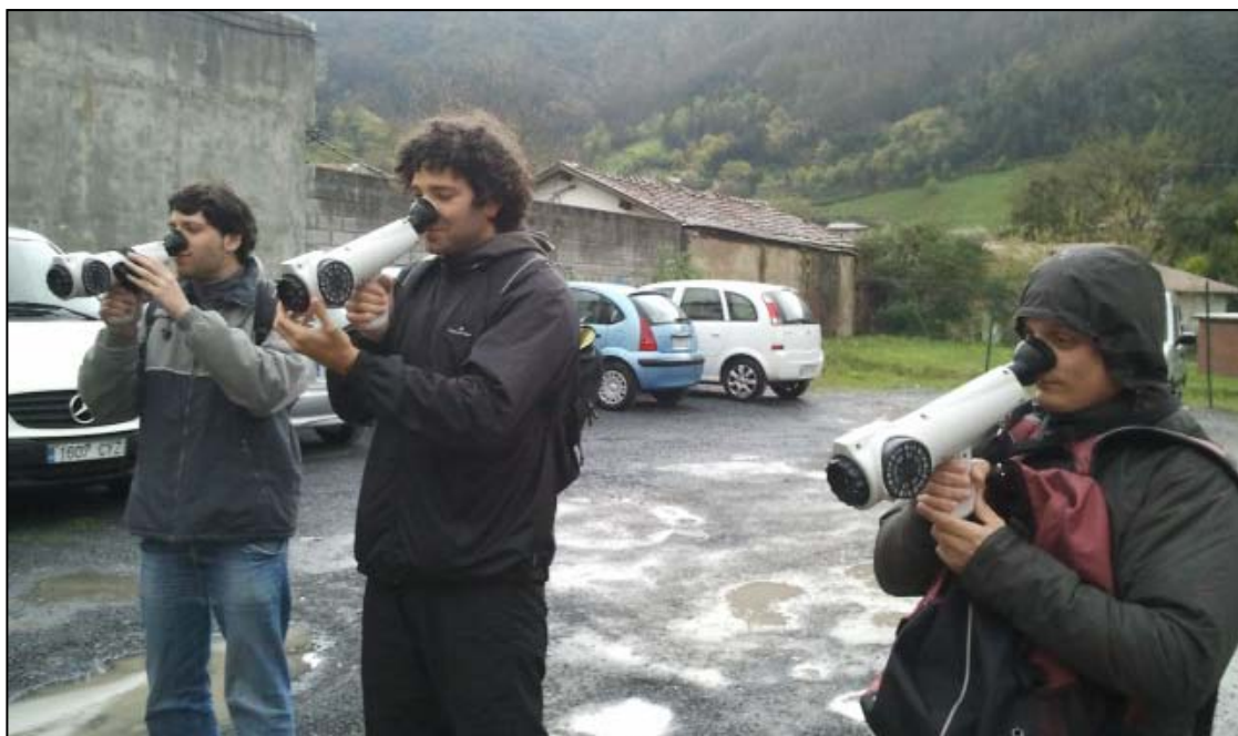
Figura 2.3: Ejemplo de pruebas de intercomparación de mediciones “in situ” simultaneas entre los técnicos panelistas
