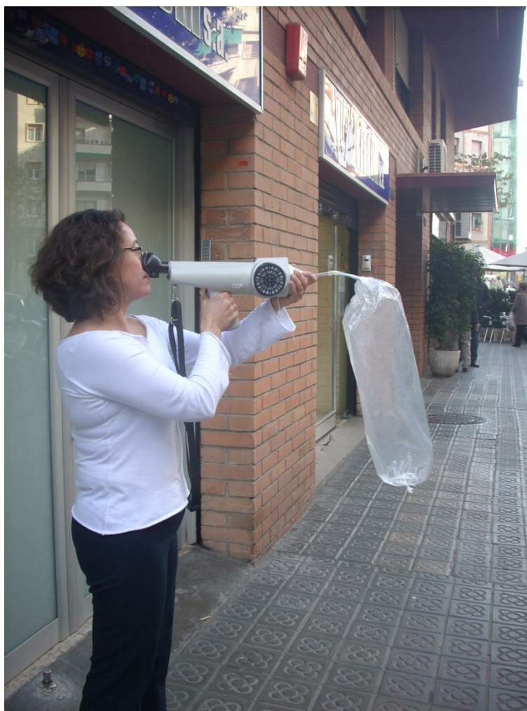
Ejemplo de verificación de la percepción de olor en una bolsa de Nalophan conteniendo una dilución de n-butanol con aire sintético
