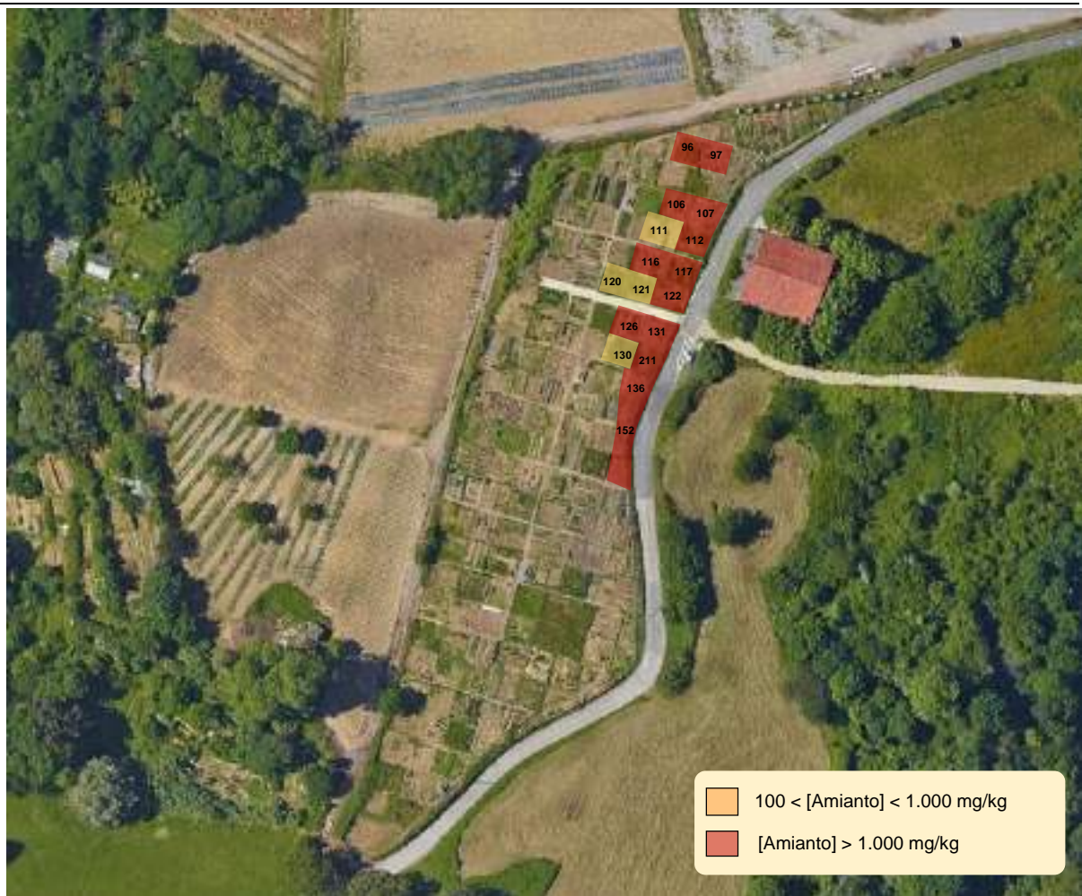
Figura 3. Parcelas afectadas por altas concentraciones de amianto
