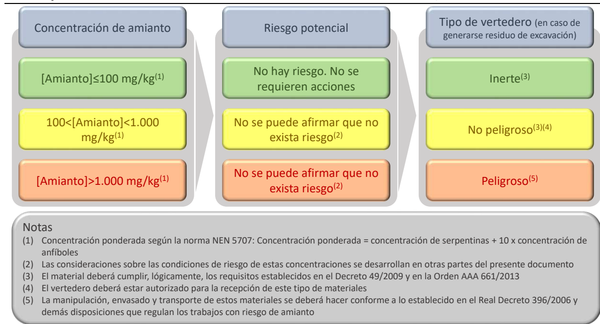
Figura 13. Consideraciones sobre la concentración de amianto en el suelo y residuos de excavación
