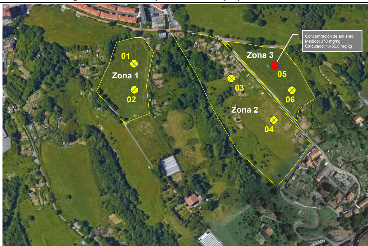
Figura 2. Ubicación de los puntos de muestreo y superación de amianto
