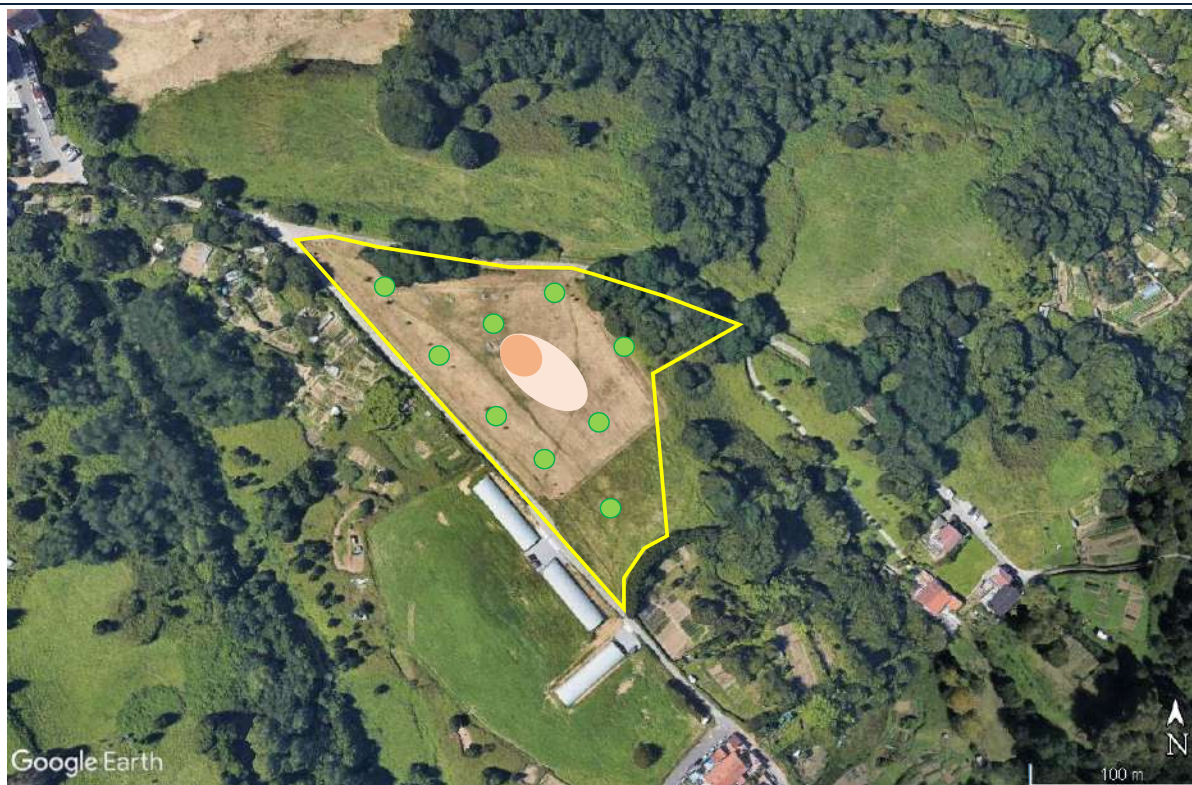
Figura 11. Estimación de la zona afectada por amianto
