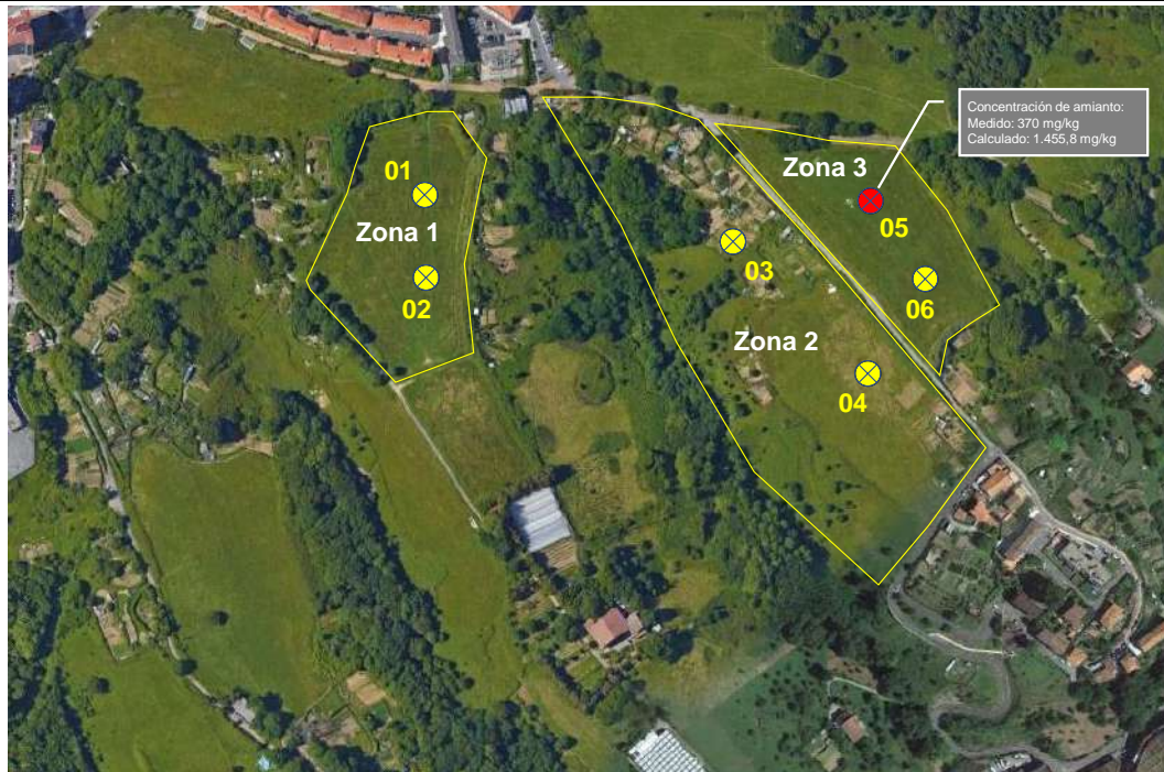
Figura 3. Ubicación de los puntos de muestreo y superación de amianto
