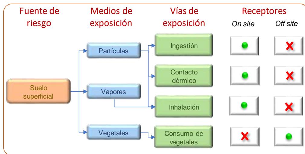
Figura 6. Modelo conceptual general para el establecimiento de hipótesis de escenarios de riesgos
