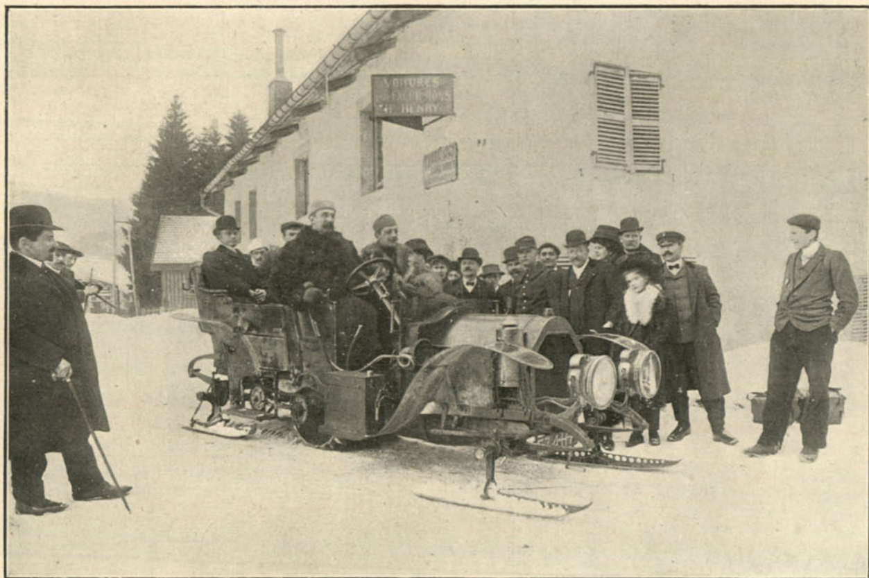
El nuevo trineo-automóvil de M. La Barre, con el que está verificando diferentes pruebas sobre la nieve.
