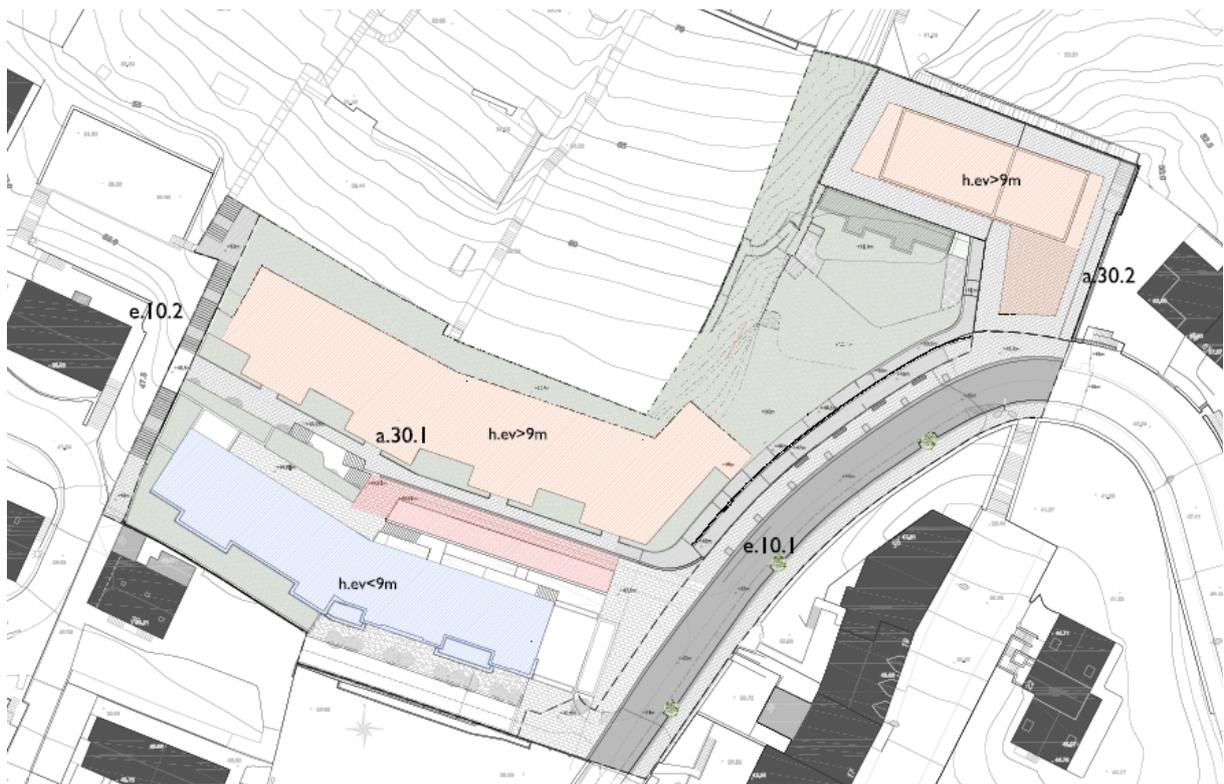
El espacio de maniobra se encuentra entre la primera sección del bloque superior y el bloque inferior derecho. Tiene un perfil inclinado, con una pendiente inferior al 6% (aprox. 4%), debido a que tiene carácter de espacio público. Arranca aproximadamente a cota +43,50 m. y asciende hasta cota +44,81 m.
