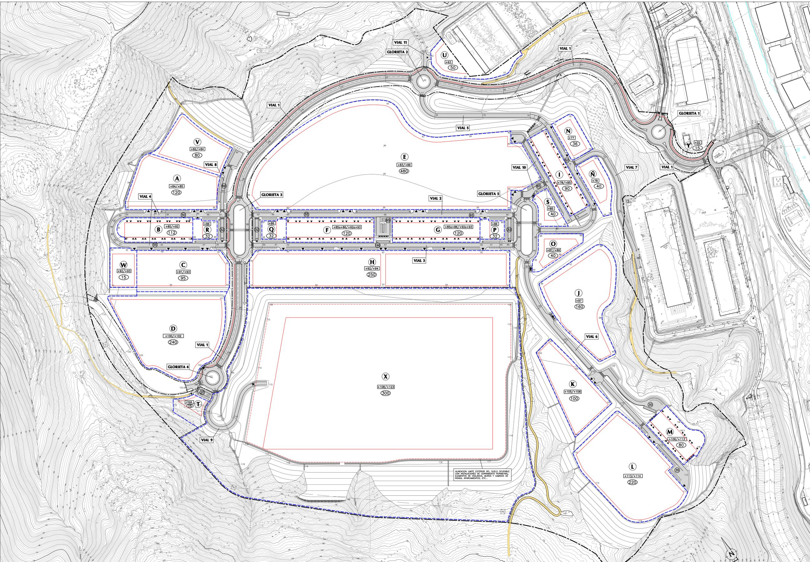
ALINEACION LIMITE EXTERIOR DEL SUELO OCUPABLE CON INTRUSIONES DE SERVICIO PERIMETRAL ELEMENTOS DE VIGILANCIA, MUROS Y CAMINOS DE RUIDO, APARCAMIENTOS, ETC.
