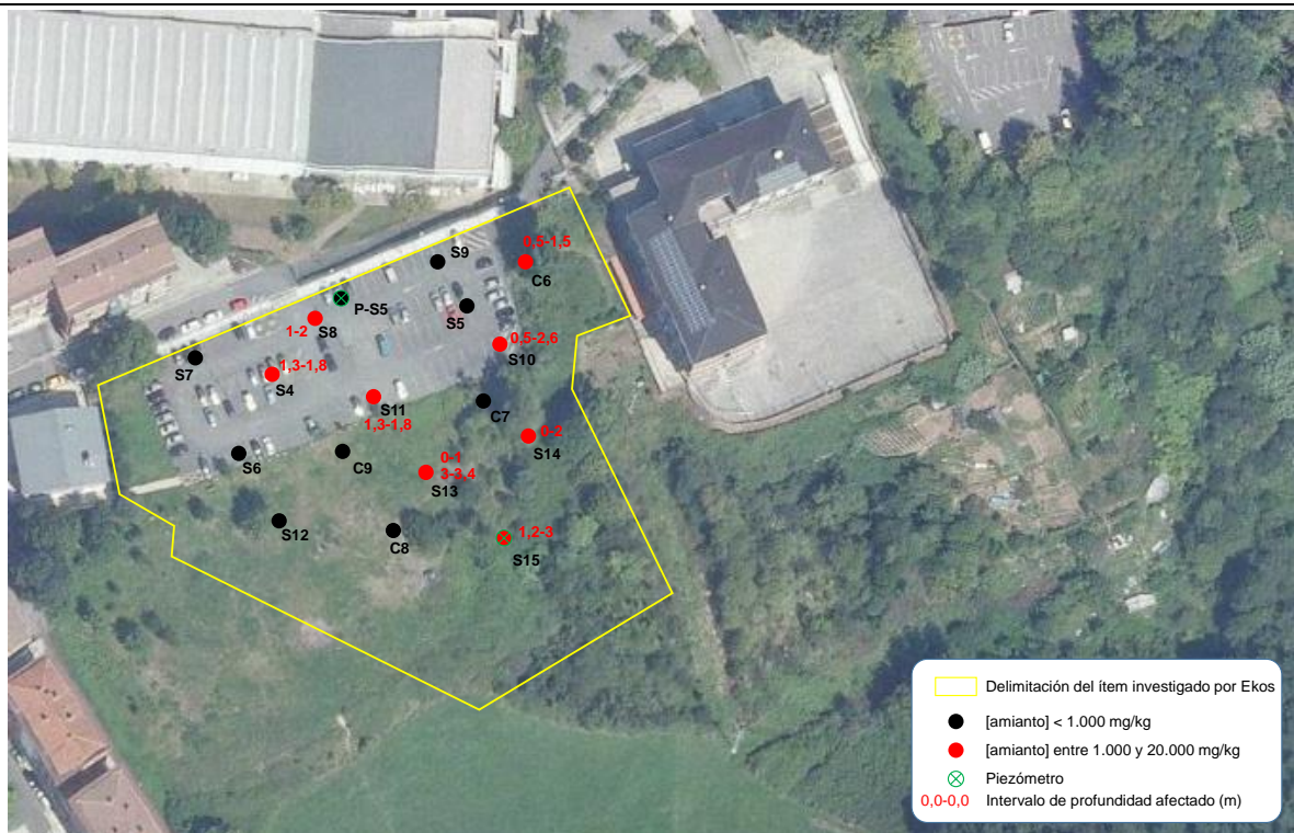
Figura 3. PDM con concentración de amianto superior a 1.000 mg/kg
